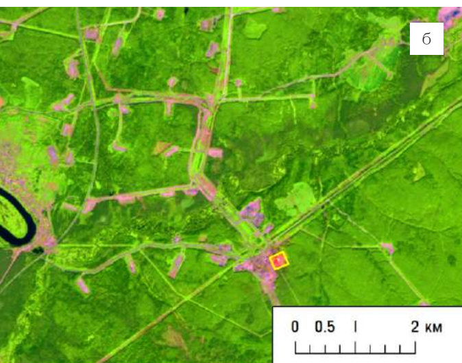
Рис. 3.11.8. Разрабатываемое нефтяное месторождение на снимке Sentinel-2 летнего сезона в синтезе естественных цветов (а), и в синтезе SWIR-NIR-RED (б), прямоугольником выделен факел сжигания попутного газа
