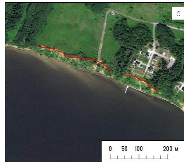
Рис. 3.1.3. Оползень на берегу Чусовского залива Камского водохранилища на снимках: а) Sentinel-2, пространственное разрешение 10 м и б) WorldView-2 (0,5 м), в синтезе естественных цветов. Красной линией показана стенка отрыва оползня
