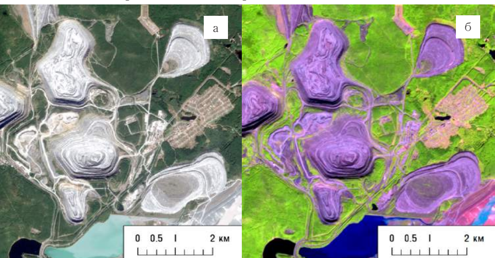
Рис. 3.11.6. Карьеры по добыче металлургического сырья (железной руды) в г. Качканар. Снимок Sentinel-2 в синтезе естественных цветов (а), и в синтезе SWIR-NIR-RED (б)
