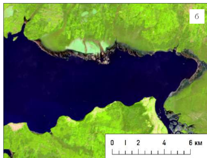
Рис. 3.4.9. Зона переменного подпора Камского водохранилища на снимках, полученных в период низкого (а) и нормального (б) уровней воды, синтез каналов SWIR-NIR-RED
