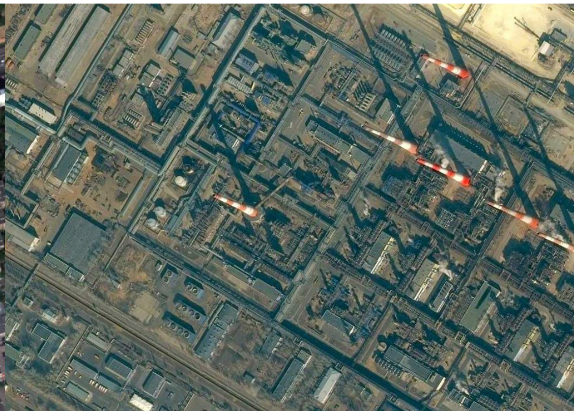
Рис. 1.1.2. Пример снимка высокого разрешения: SPOT 6-7, 1,5 м (панхроматический); 6 м (мультиспектральный)
