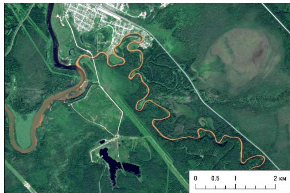
Рис. 3.11.17. Загрязнение реки кислыми водами с высокой концентрацией железа, изливающимися из затопленных шахт Кизеловского угольного бассейна. Снимок Sentinel-2 в синтезе естественных цветов
