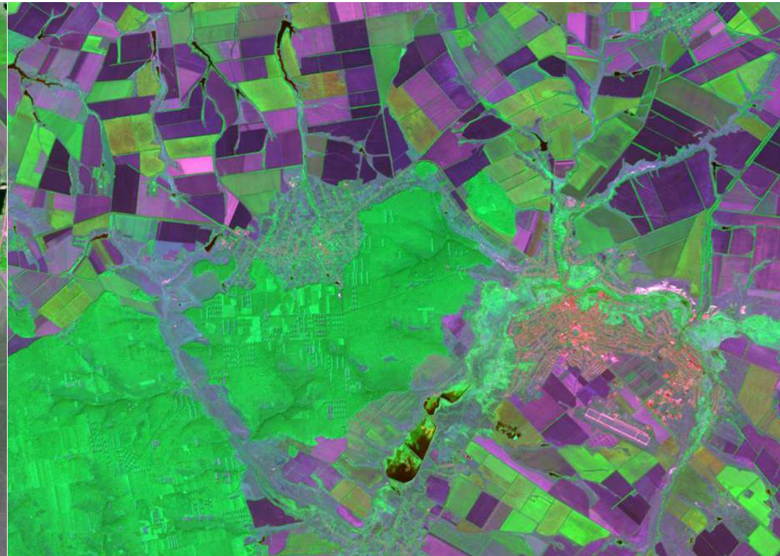
Рис. 1.1.4. Пример снимка среднего разрешения: LANDSAT-8, 15 м (панхроматический); 30 м (мультиспектральный)
