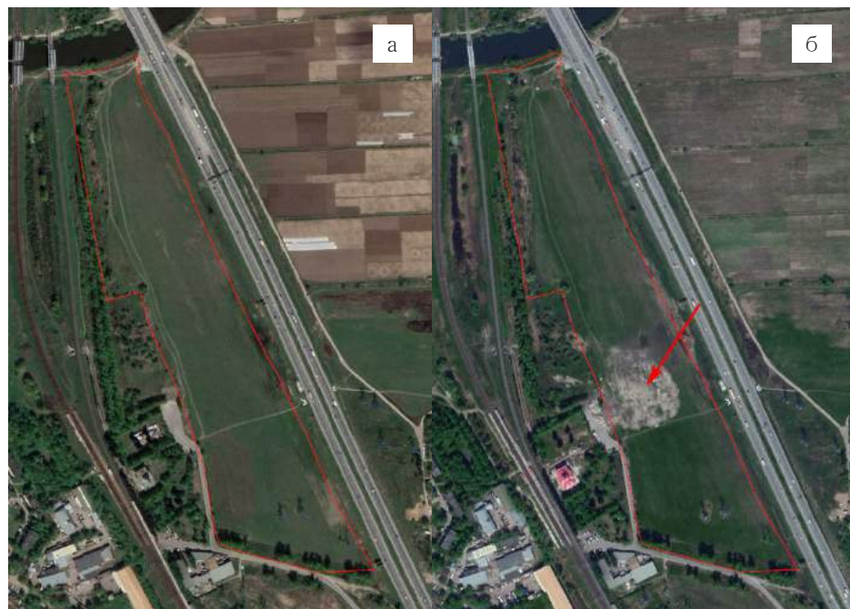
Рис. 3.10.12. Захламление сельскохозяйственного угодья. Красной линией обозначены границы земельного участка. Разрешенное использование участка – для сельскохозяйственного производства. Снимки сверхвысокого разрешения с открытого картографического сервиса. Дата снимка: а) 15.05.2017; б) 07.05.2018. Красной стрелкой указан захламленный участок, примыкающий к железнодорожной станции
