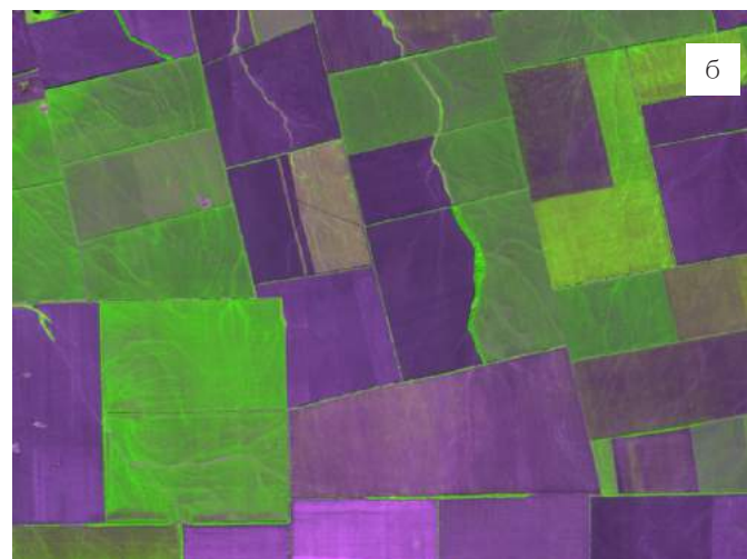
Рис. 3.9.1. Отображение пашни с посевами сельскохозяйственных культур в разной стадии вегетации на снимке Sentinel-2B: а) в натуральной цветопередаче (RED-GREEN-BLUE); б) в искусственной цветопередаче (GREEN-NIR-RED).
