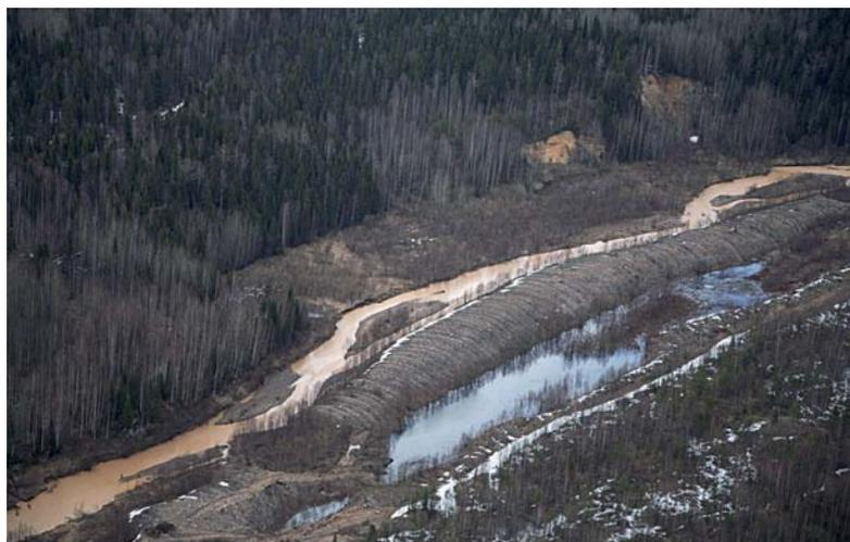
**Рис. 2.13 (б).** Пойма р. Большой Колчим, переработанная драгой (фото из архива ГИС центра ПГНИУ)
