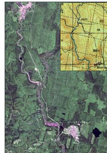
**Рис. 2.14.** Измененное русло р. Северный Колчим в результате добычи алмазов дражным способом (на топокарте изображено русло реки до начала добычи)
