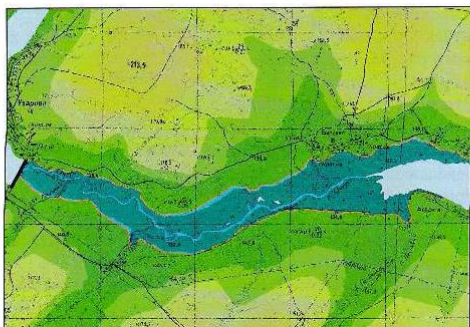
Рис. 1.4. Моделирование зоны затопления при половодье
