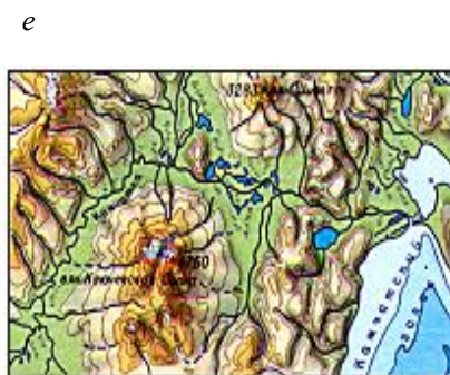
Рис. 13. Способы картографического изображения рельефа ( a – горизонталей; б – горизонталей, гипсометрической окраски; в – горизонталей, штрихов крутизны; г – горизонталей, гипсометрической окраски, штрихов крутизны; д – горизонталей, отмывки; е – горизонталей, гипсометрической окраски, отмывки)
