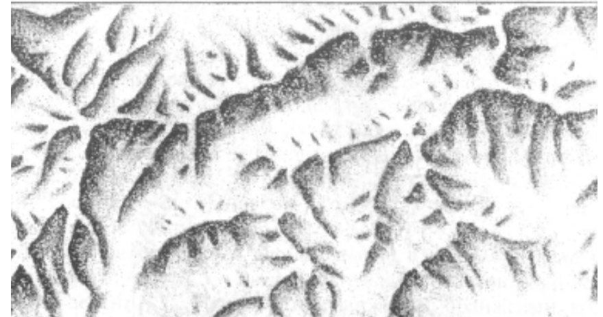
Рис. 68. Отмывка рельефа при северо-западном освещении (Верещака, 2016)
