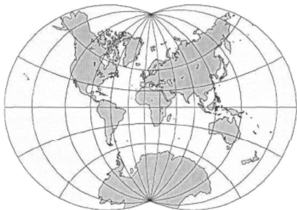
Рис. 17. Равноугольная круговая поликоническая проекция Лагранжа (Серापинас, 2005)
