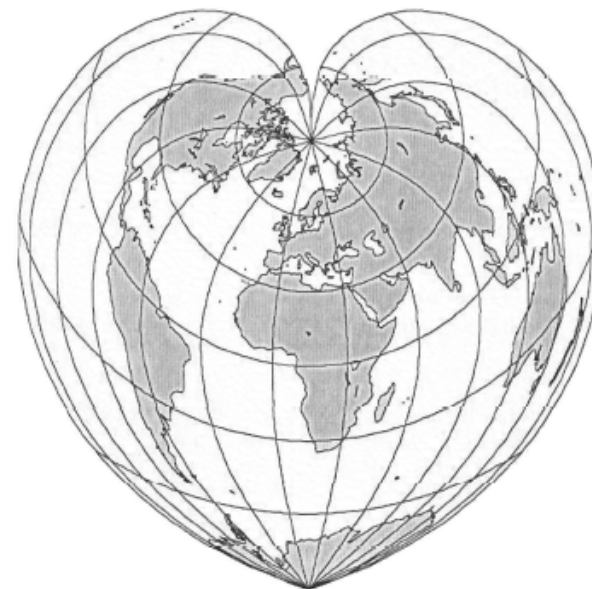
Рис. 21. Псевдоконическая «сердцевидная» проекция Вернера (Серापинас, 2005)
