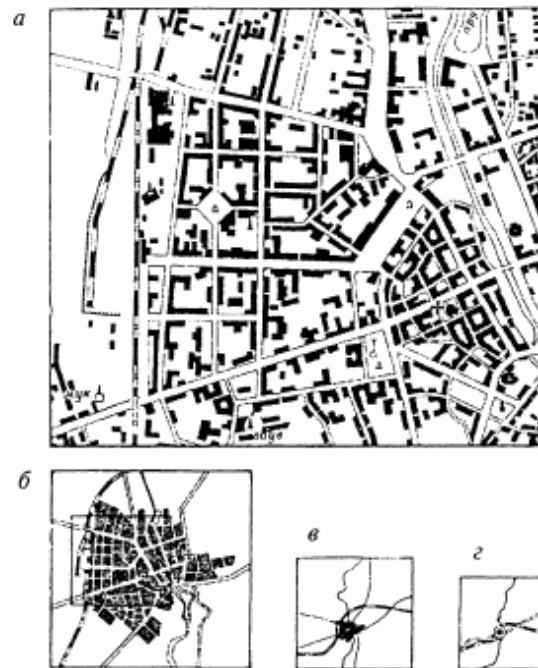
Рис. 31. Генерализация населенного пункта. Замена отдельных объектов (здания – а) собирательными знаками (кварталы – б, общий контур города – в) и абстрактным значком (пунсон – г) (Берлянт, 2001)
