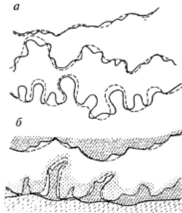
Рис. 33. Нарушение геометрической точности при обобщении извилистых рек (а) и береговых линий (б) (Берлянт, 2001)
